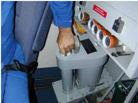
圖 5. NOAA G4 dropsonde 儲存箱和投擲發射器 (劉清煌拍攝)。
