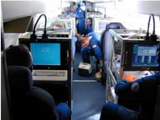
圖 4. NOAA G4 機艙內部工作環境，照片前端左右兩台工作機櫃都是 Vaisala AVAPS 處理終端機，每一台終端機可同時處理四份 dropsonde。
