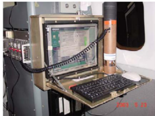
圖 8. 機上電腦系統及投落送探空儀及其訊號接收系統設備圖。
